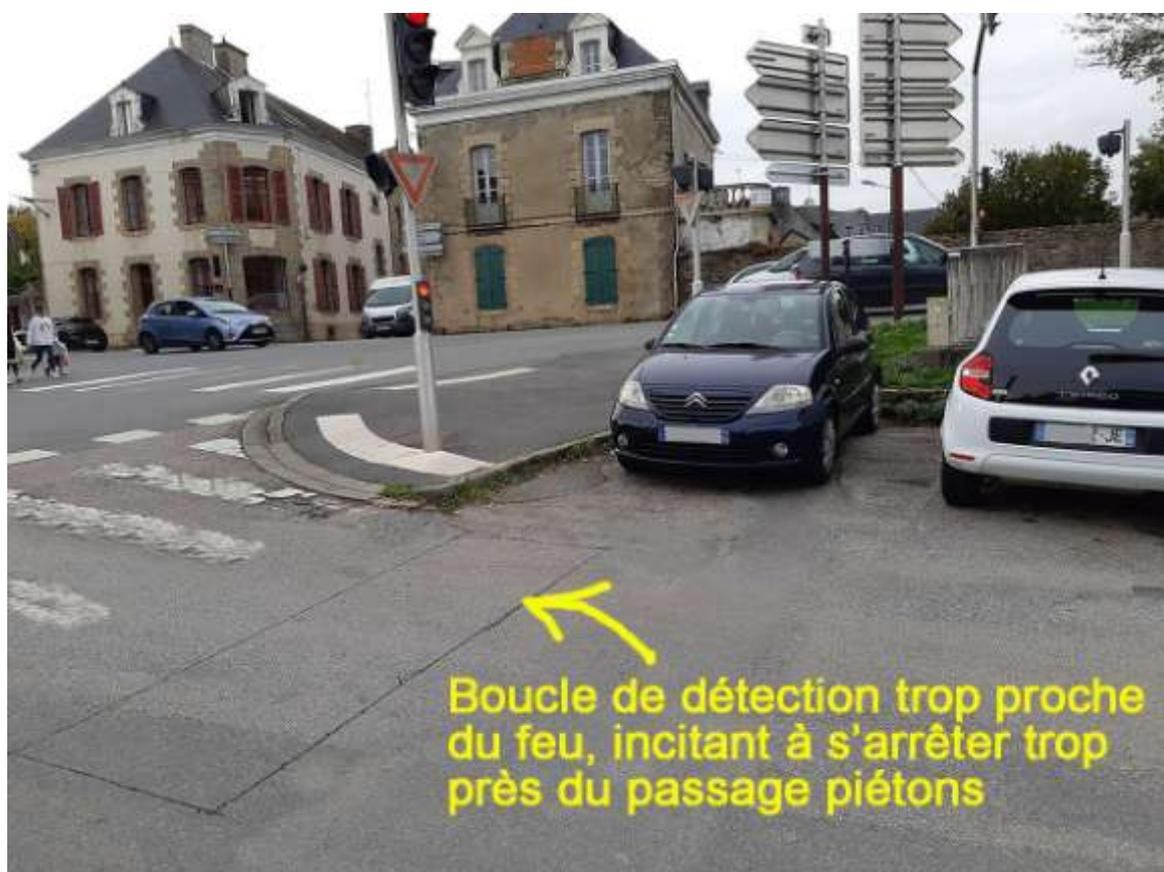
**Préconisation N° Pour les maires :** si une boucle de détection des véhicules aux feux est installée, il faut l'implantées à plus de 7 mètres du feu.
