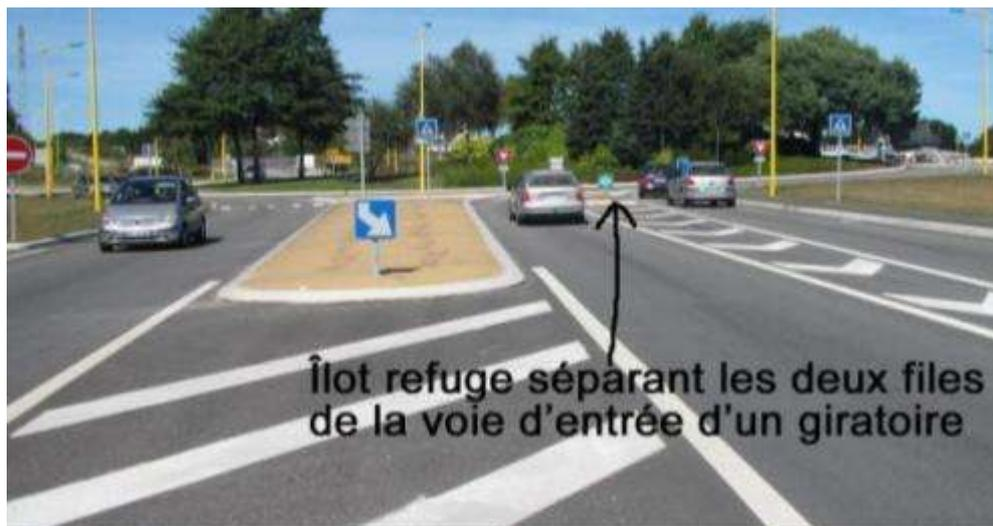
**Préconisation N° Giratoires :** Sur la bretelle d'entrée, placer un refuge central entre les deux voies au cas elle comporte 2 voies.
