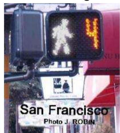
**Préconisation N°** - Installer, sur les carrefours à feux, le décompte chiffré du nombre de secondes de vert restant pour traverser, en veillant bien que ce ne soit pas au détriment du temps accordable aux piétons, c'est-à-dire qu'il ne faut pas qu'il y ait plus de 2 ou 3 secondes entre le chiffre zéro et l'allumage du feu vert des voitures. Il est possible et adroit, de personnaliser les derniers chiffres ( 3, 2, 1, 0) en faisant clignoter la figurine verte
