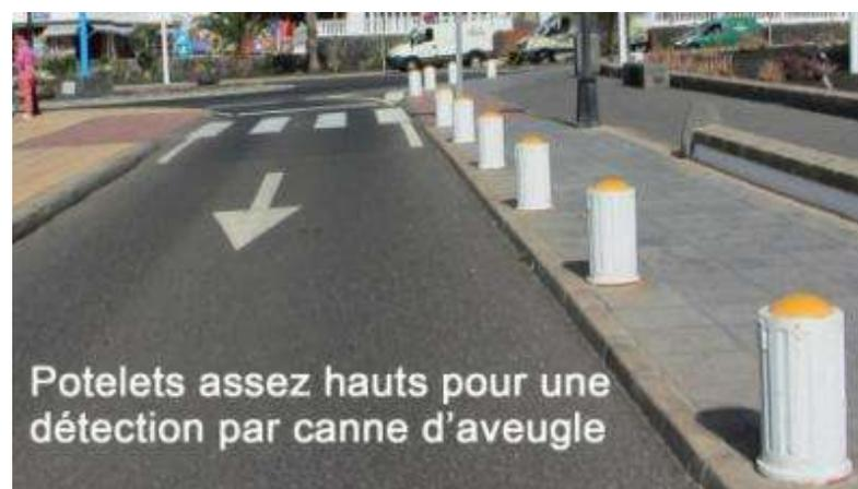
**Préconisation N°** : à destination des maires : Pour combattre le stationnement illégal sur les trottoirs, une solution est d'y placer des potelets HAUTS, plastique ou bois, ou des bornes pierre ou béton HAUTES avec partie supérieure arrondie enfants
