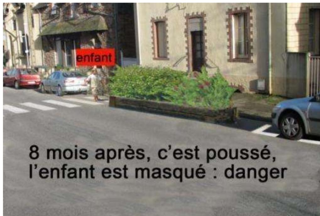
**Préconisation N°** Proscrire absolument de placer de la végétation, qu'elle soit en bac ou en terre, dans les 5 mètres avant les passages piétons, ni sur la chaussée, ni sur bord du trottoir.
