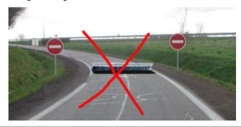
**Préconisation N°** pour éviter que les conducteurs entrent à contresens par la bretelle de sortie, éviter d'envisager des solutions "mécaniques" car elles ne peuvent pas être généralisées et sont dangereuses en cas de dysfonctionnement.
