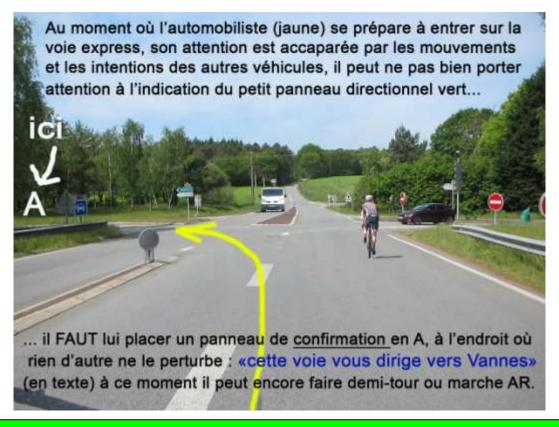
**Préconisation N°** pour éviter que le conducteur s'engage par erreur dans la mauvaise bretelle d'entrée, l'informer 2 fois de son errer : une première fois quand il vient de s'y engager (10 m) en plaçant une signalisation <u>supplémentaire</u> sur la bretelle lui indiquant vers quelle destination lui conduit cette bretelle : "cette voie vous dirige vers Vannes". Il peut encore faire marche arrière.
